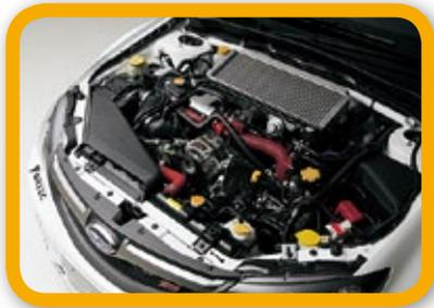
エンジンの改造は規則により厳しく制限され、コンピュータについてはノーマル置き換えタイプであれば交換可能となっています。また、ターボ付き車両はグループN同様、吸気リストリクターの装着が義務付けられています。
